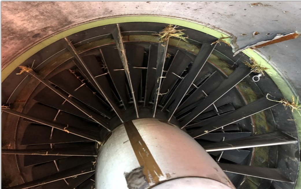
Fotografía No. 4: Daños en alabes motor No. 1
