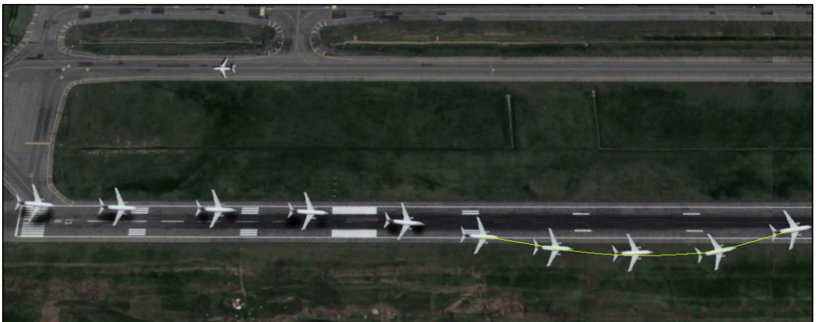
Fotografía No. 2: Secuencia de la aeronave durante el contacto con zona de seguridad y pista
