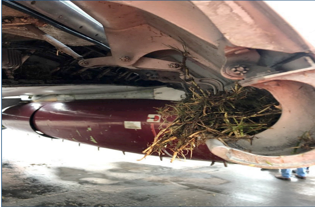
Fotografía No. 3: Daños causados en plano izquierdo.
